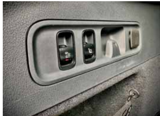
Ist Luftfederung an Bord, lässt sich das Heck zur einfacheren Beladung absenken
