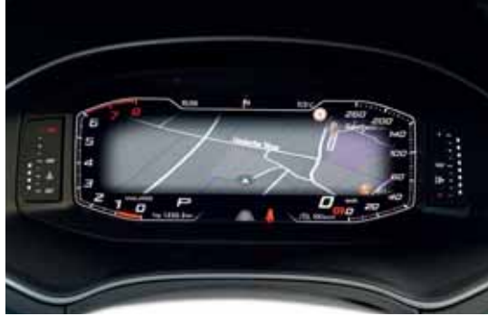
Das Kombiinstrument besteht beim Arona aus TFT-Fläche (li.)
