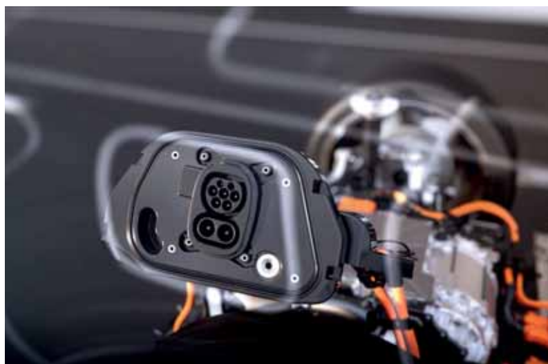
Der CCS-Anschluss überträgt viel Strom in kurzer Zeit
