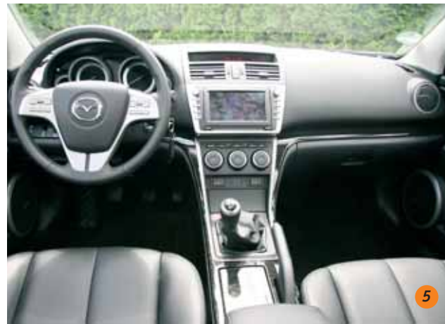
1. Nahezu alle Bedieneinheiten befinden sich auch am Lenkrad
