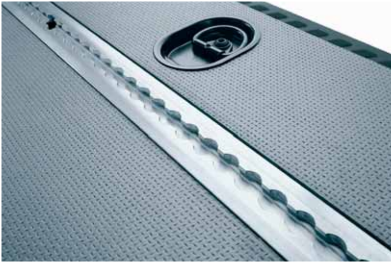
Passive Ladungssicherung mit konstruktiven Hilfsmitteln ab Werk: Neben Verzurrösen gibt es optional auch Schienensysteme (hier im VW Crafter)
